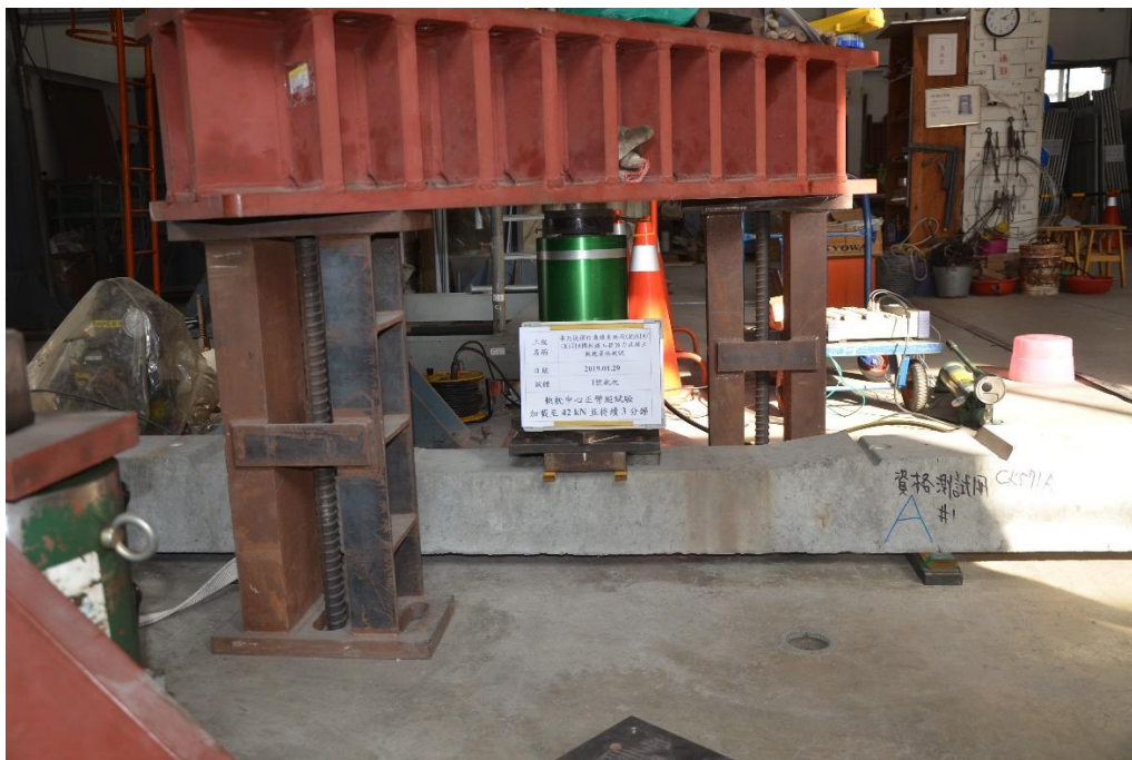
軌枕中央正彎矩試驗 (無碴鋼筋混凝土軌枕不適用)
