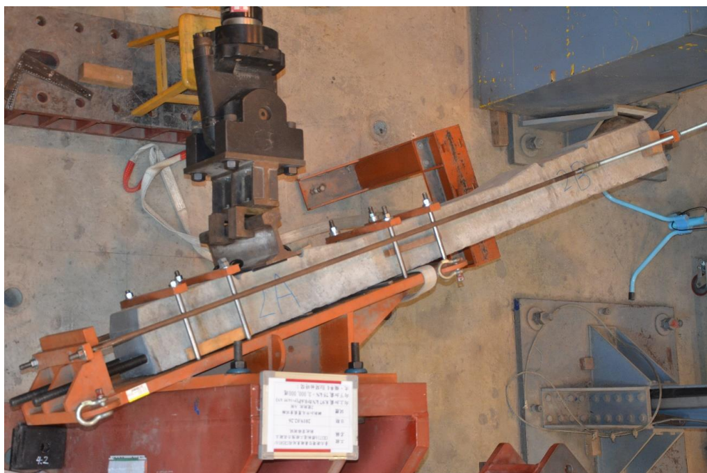
鋼軌扣件反覆載重試驗
