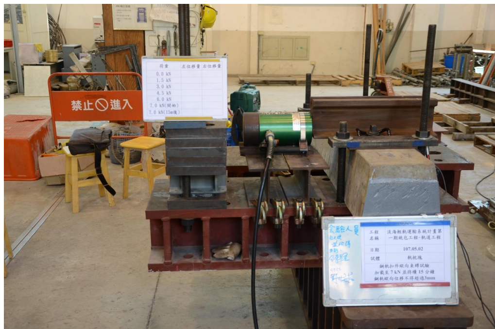
鋼軌扣件縱向束縛試驗
