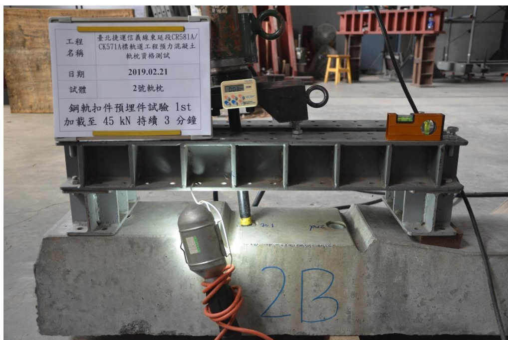
鋼軌扣件預埋件試驗
