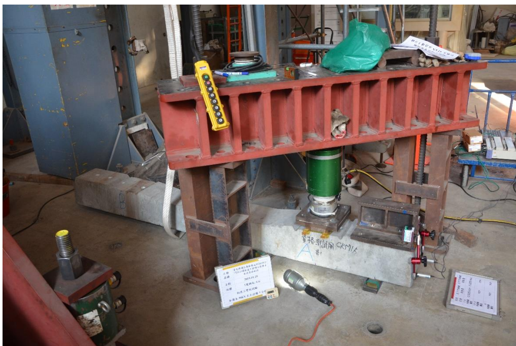
握裹發展、鋼鍵錨定、及極限負載試驗 (無碴鋼筋混凝土軌枕不適用)
