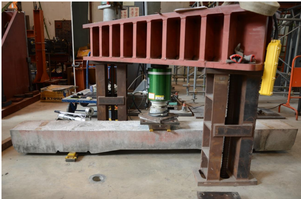
軌枕中央負彎矩試驗 (無碴鋼筋混凝土軌枕不適用)
