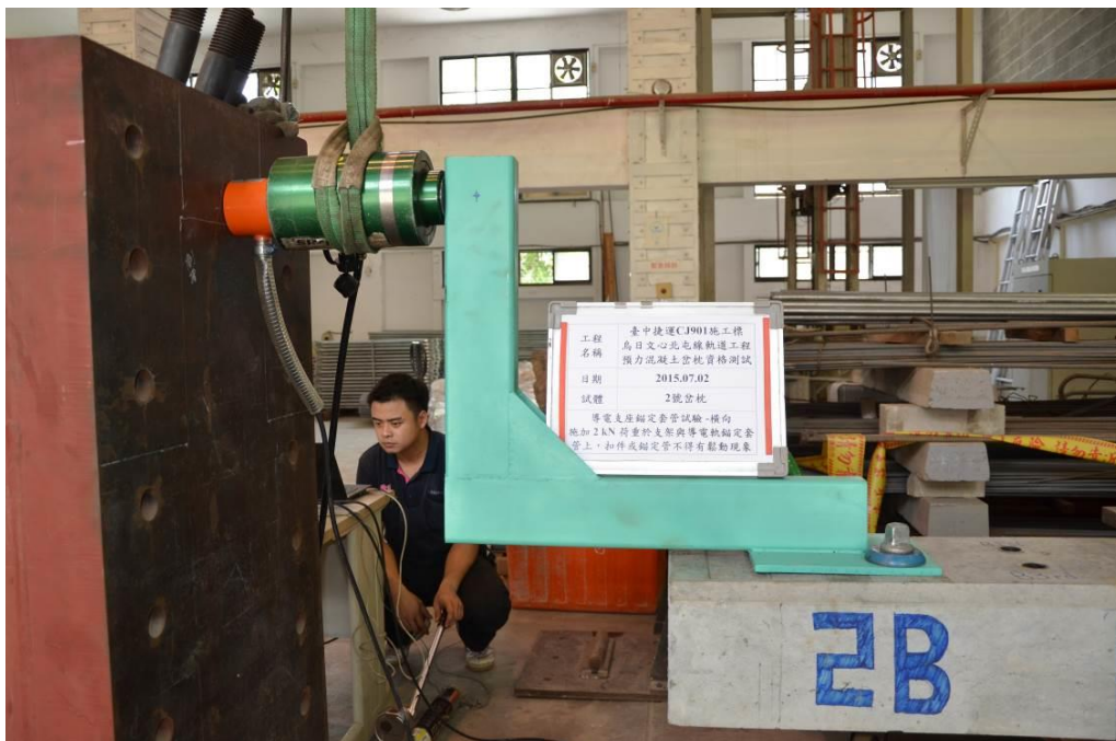
導電軌支座錨定套管試驗
