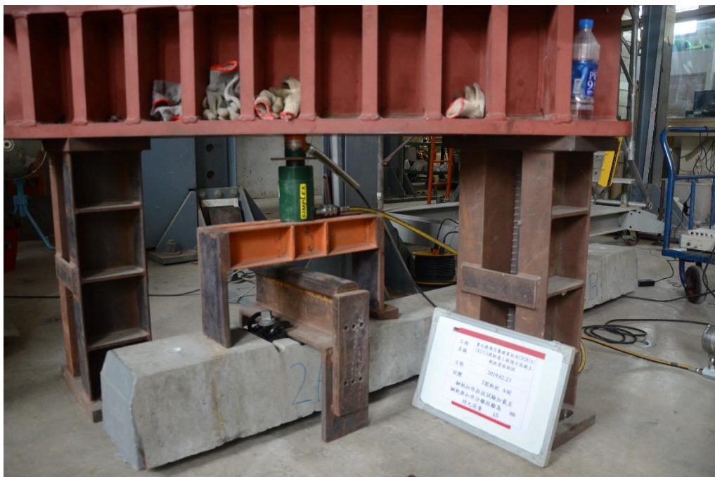
鋼軌扣件拉拔試驗
