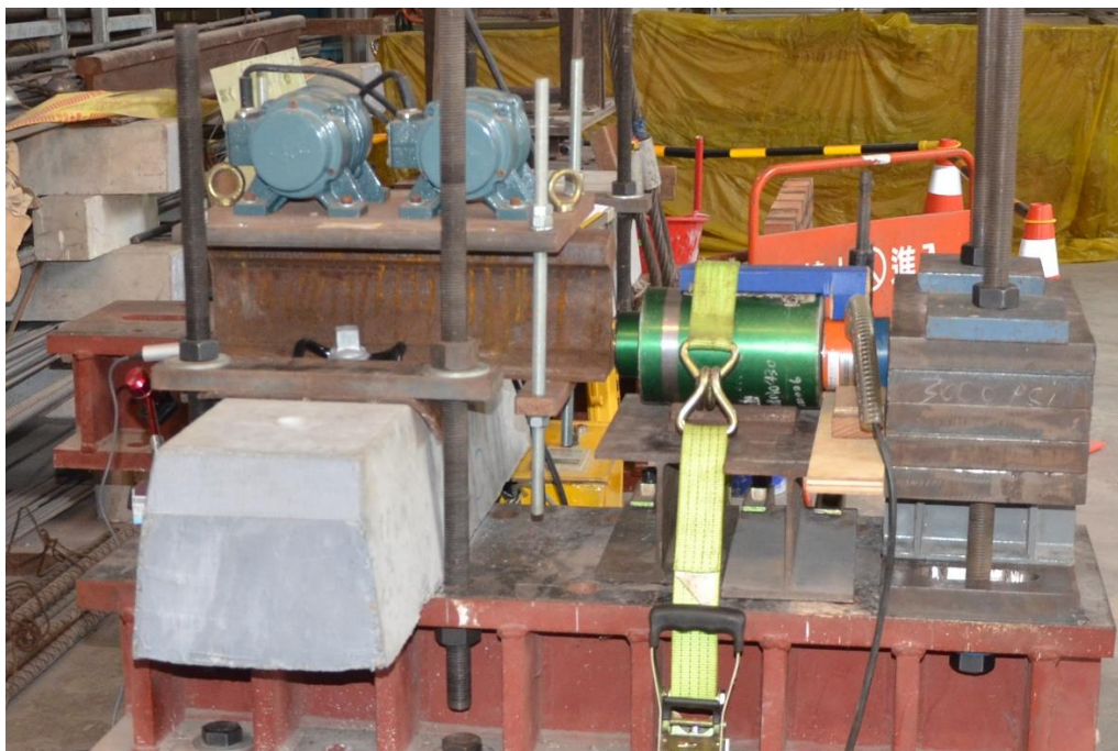
鋼軌扣件動態爬行試驗
