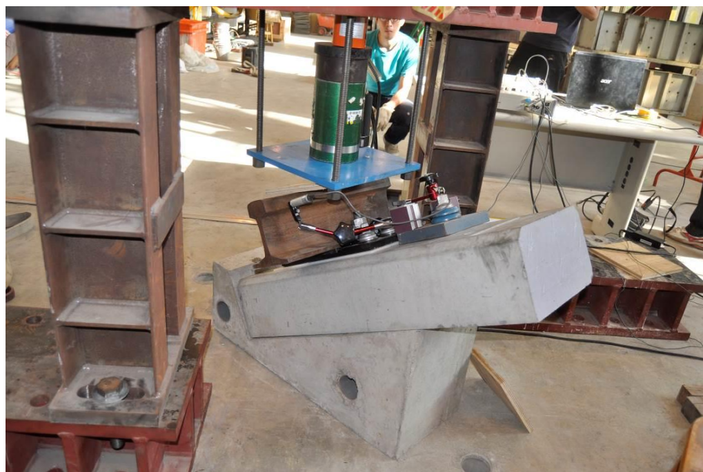
鋼軌扣件橫向束縛試驗
