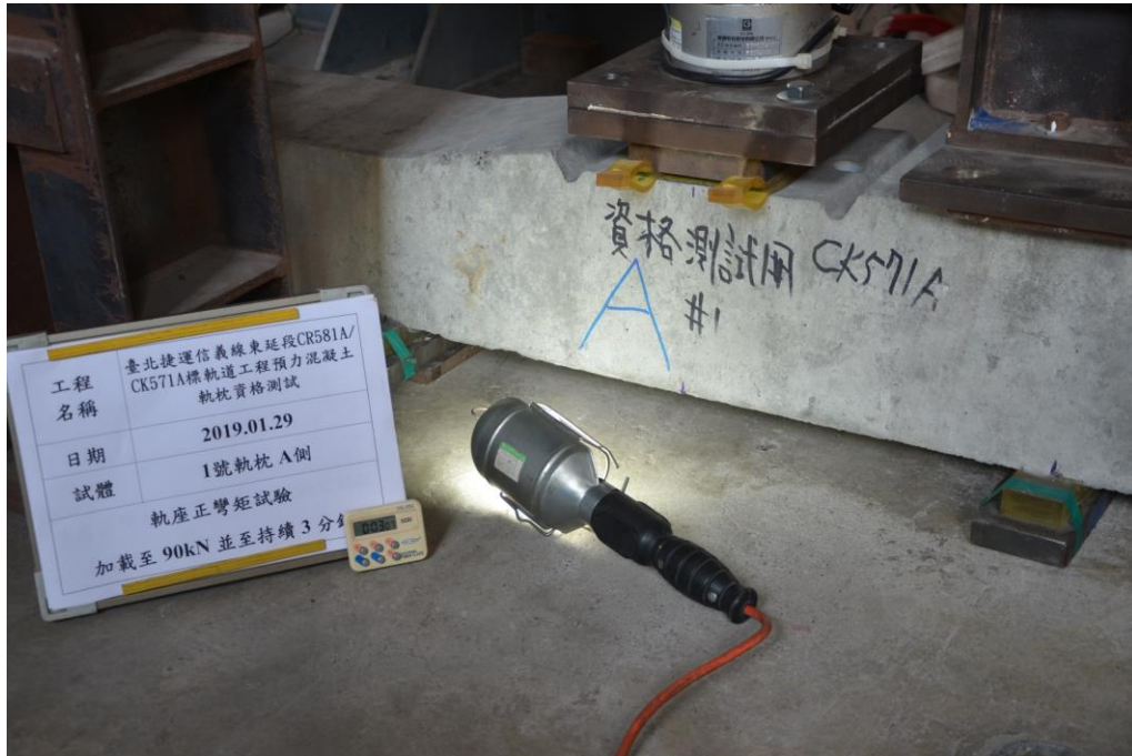
軌座正彎矩試驗 (無碴鋼筋混凝土軌枕不適用)
